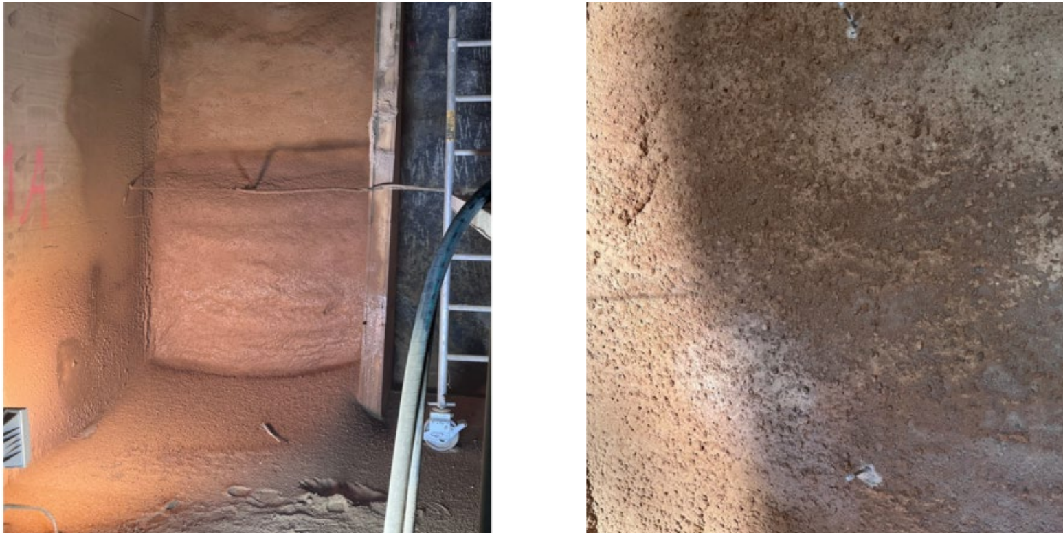
Großspritzkasten mit Salz- und silikatischem Zuschlag
